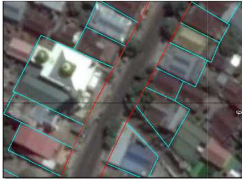
Gambar 3 1. Hasil dari overlay dan erase antara lahan sebelum pelebaran dan badan jalan yang telah dilebarkan
